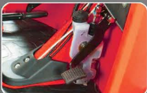
Sistema hidráulico de frenos. (tipo automóvil)
