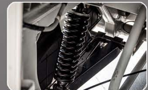
Suspensión trasera (Nuevo diseño de amortiguador).
