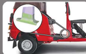
Doble refuerzo en arco de polvera y poster central.
