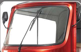
Parabrisas con vidrio laminado tipo automóvil.
