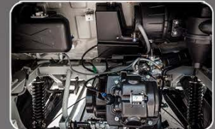
Motor de 10 Hp @ 5500 rpm y torque de 15.5 Nm @ 3250 rpm.
