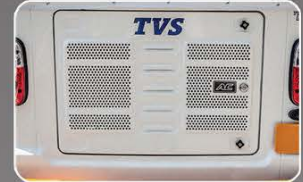
Puerta trasera ventilada. Mejora la circulación de aire.
