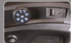
Sistema de audio con FM, USB-MP3 y entrada de auxiliar.
